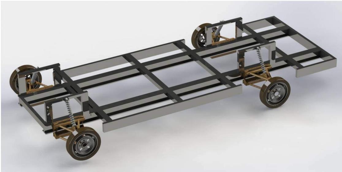
Gambar 5.3 Model Solid Chassis yang Disimulasikan
