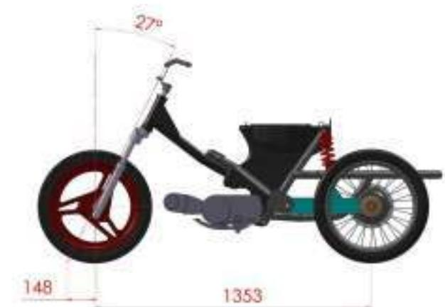
**Gambar 2.** Parameter Sepeda Motor Roda Tiga dengan Suspensi Rigid
