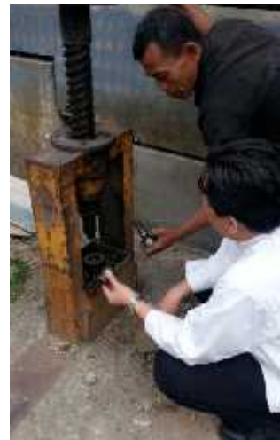
Gambar 20 Proses press ball joint dengan mesin press menggunakan ulir daya
