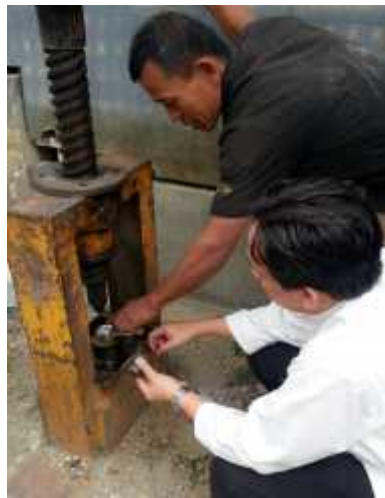
Gambar 20 Proses press ball joint dengan mesin press menggunakan ulir daya
