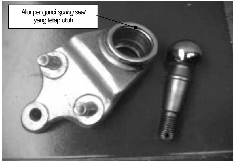
Gambar 6. Bentuk alur penutup ball-stud yang tetap utuh setelah proses pelepasan
