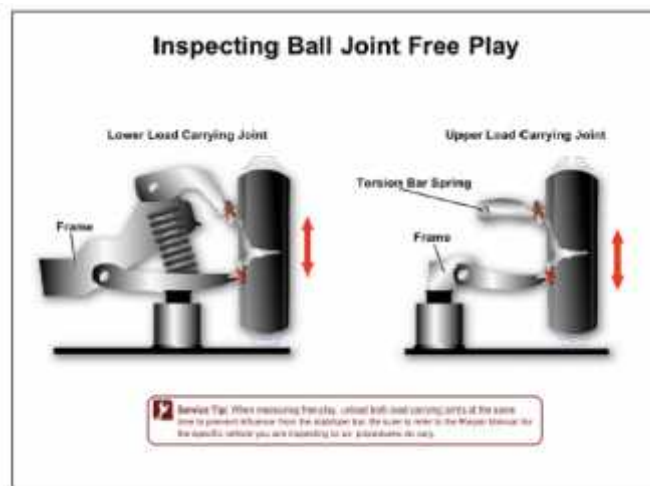
Gambar 14 Pemeriksaan Ball Joint dengan gerakan vertikal
